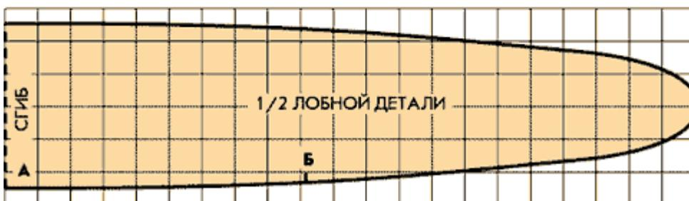
Чертеж выкройки головного убора бандана. В деталях учтены прибавки на швы, ширина которых 5 мм. Масштаб одной клеточки: 2 x 2 см.
